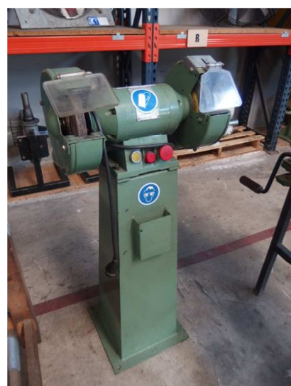
Esmeriladora 150 mm, con pedestal. BELFLEX V 150 Ref: 17558
