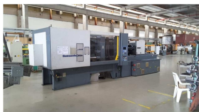
Injectora termoplástico 450 ton.con robot SEPRO
