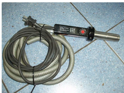
Soplante portátil retráctilador 1400 watos LEISTER DIODE Ref: LEISTER DIODE
