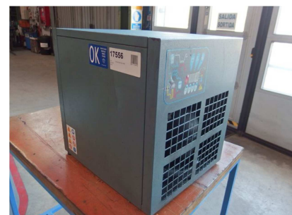
Secador de aire comprimido 60 m3/hora.
